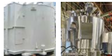
鉄製大型油密タンク SUS圧力容器(攪拌機)
